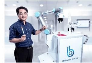
PCR自動検体採取ロボット (Brain Navi Nasal Swab Robot, NSR) は、コンピュータコントロールの自動検体採取ロボットです。コンピュータの顔認識機能により鼻の位置を自動測定した後、ロボットアームで綿棒 (Nasopharyngeal Swabs) を挟み、鼻咽頭にある分泌物(検体)を安全に採取します。被検者の条件が異なる場合、タッチパネルの操作によって適切に検査条件の設定を変更できます。
